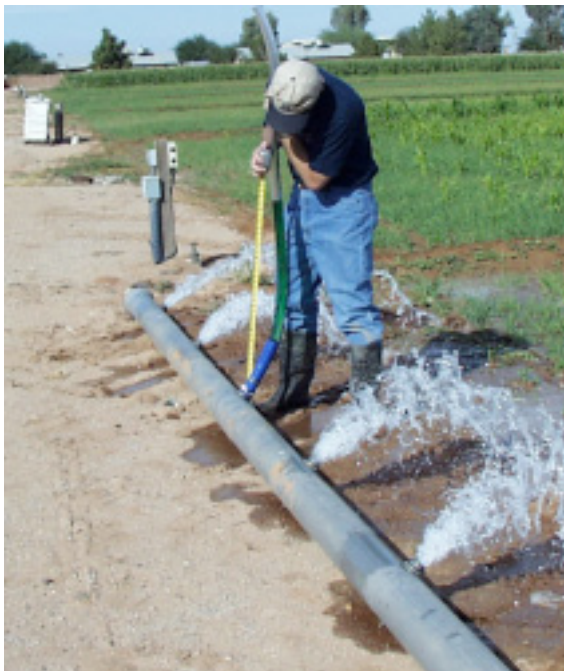
Figura 8. Estas dos fotos muestran cómo medir la carga (ft) en un sistema de tubería de compuertas. La carga es la distancia entre el nivel del agua en el tubo y el centro de la tubería. Estas son compuertas Rite-Flow™ y aquí se mide una carga de 3 pies. De acuerdo a la Tabla 8, el caudal es de aproximadamente 39 gpm por compuerta.
