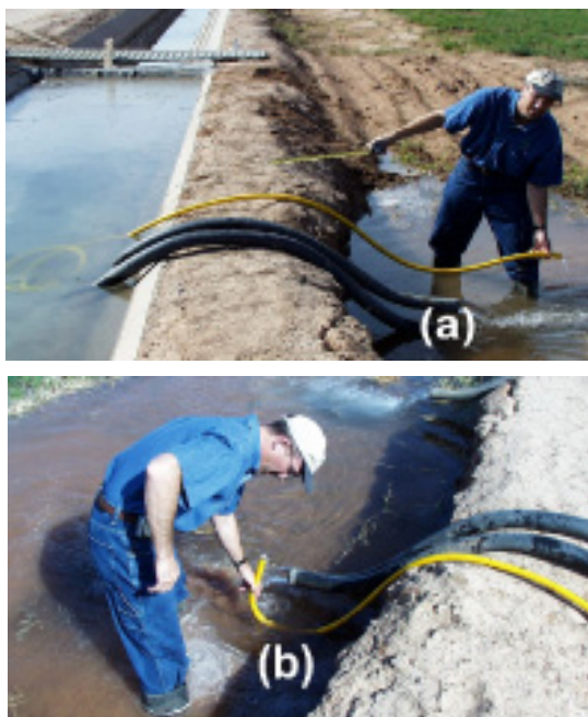
Figura 6. Tres fotos en donde se muestra cómo medir "la caída" en un sistema abierto. La caída es la distancia desde el nivel del agua en el canal hasta el nivel del agua en el campo. (a) Use la manguera para sifonear agua desde el canal; (b) Levante la manguera hasta que el agua deje de fluir y salir por la boca de la manguera; (c) Mida la distancia entre el extremo de la manguera y el nivel del agua en el campo.
