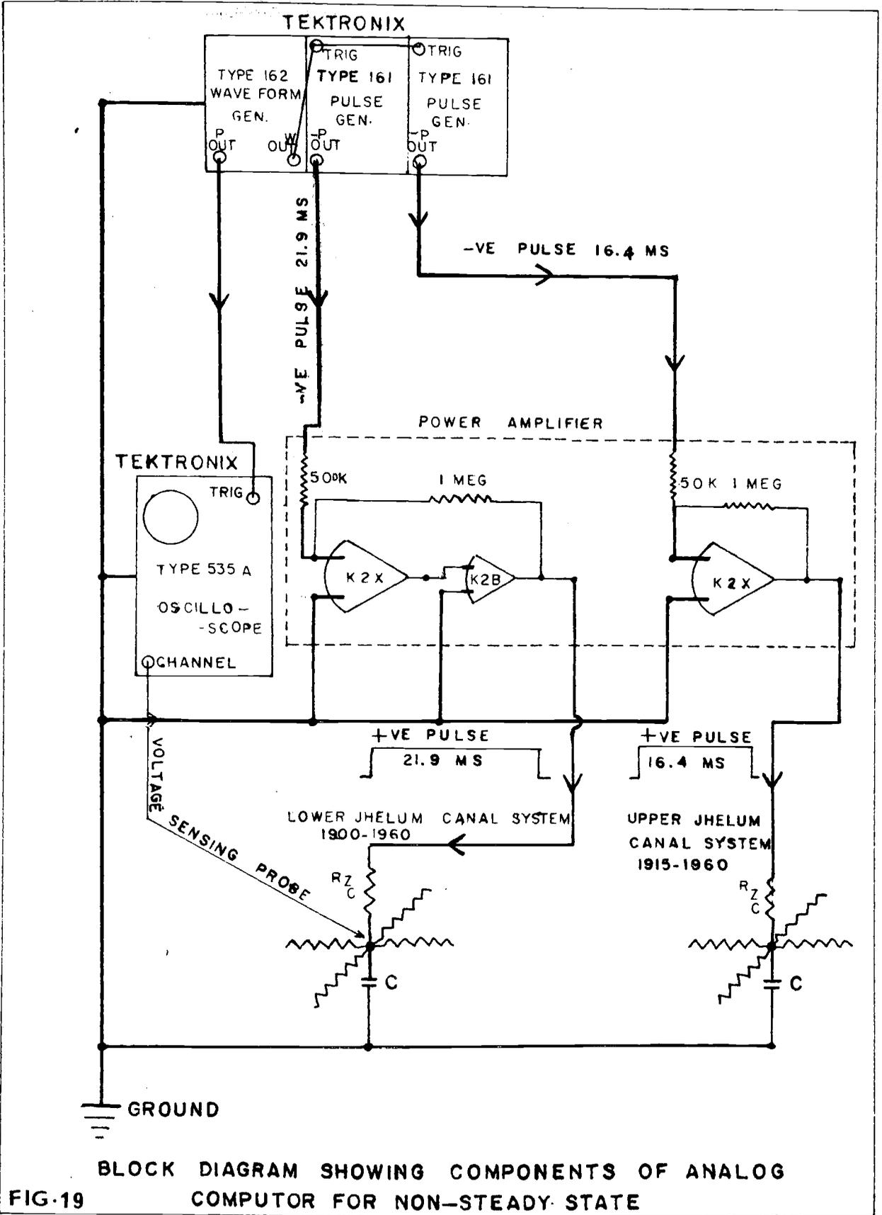
BLOCK DIAGRAM SHOWING COMPONENTS OF ANALOG COMPUTER FOR NON-STEADY STATE
