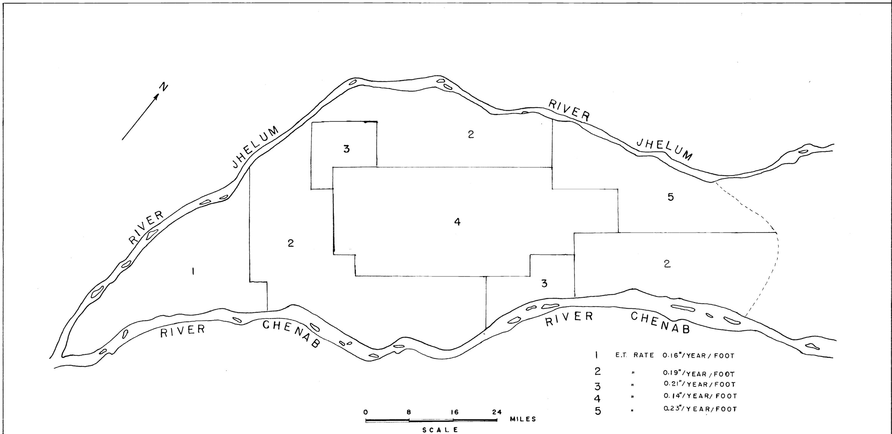
FIG. 23 MAP SHOWING ZONES OF EVAPOTRANSPIRATION RATE FOR NON-STEADY STATE
