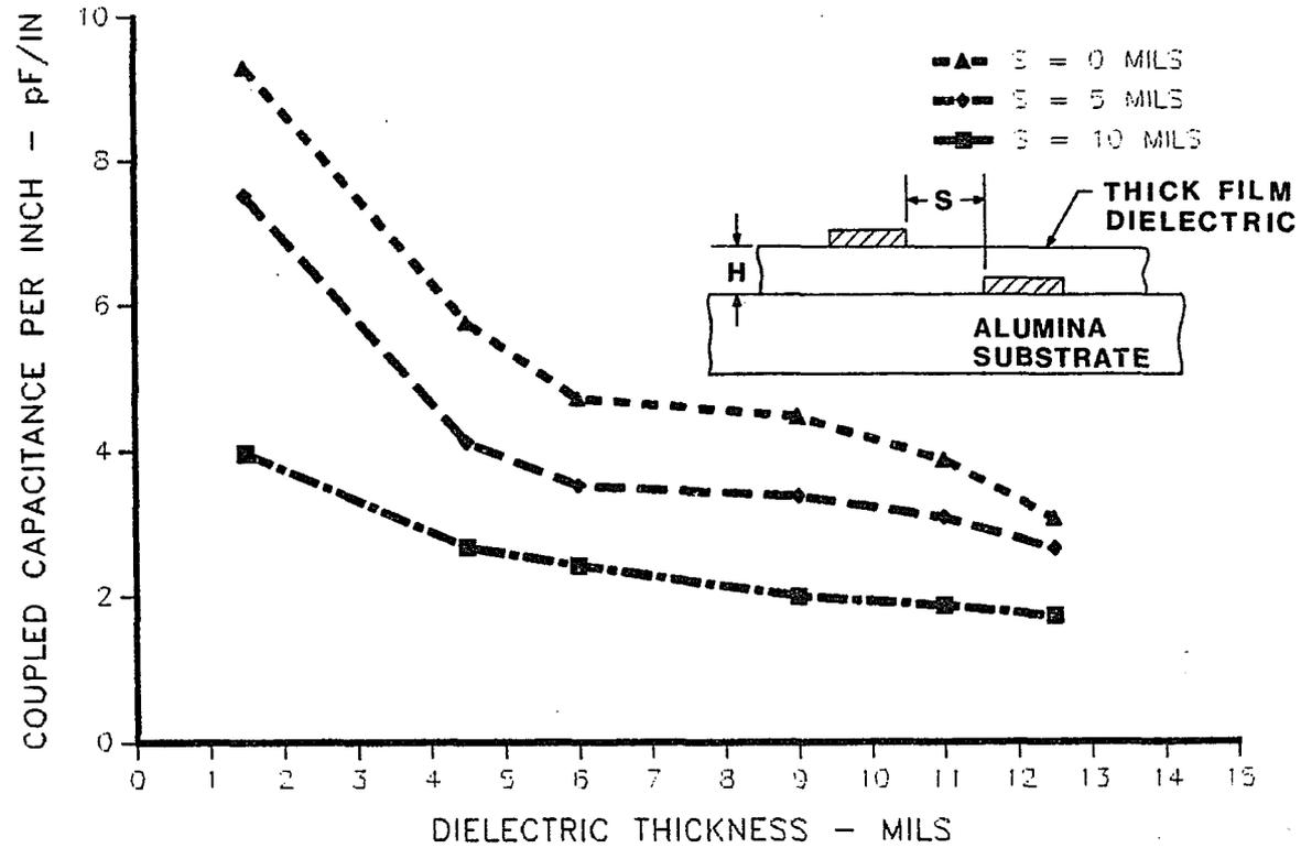
Figure 4.6 Multilayer Edge to Edge Capacitance vs. Dielectric Thickness
