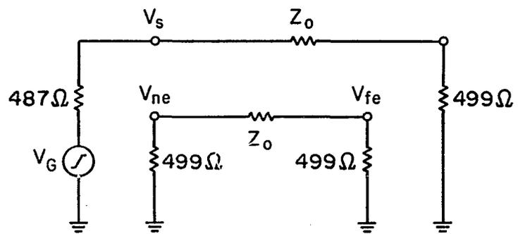
b. HIGH IMPEDANCE TEST CIRCUIT
