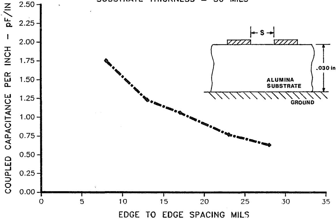
Figure 4.11 Edge to Edge Coupled Capacitance vs. Line Spacing
