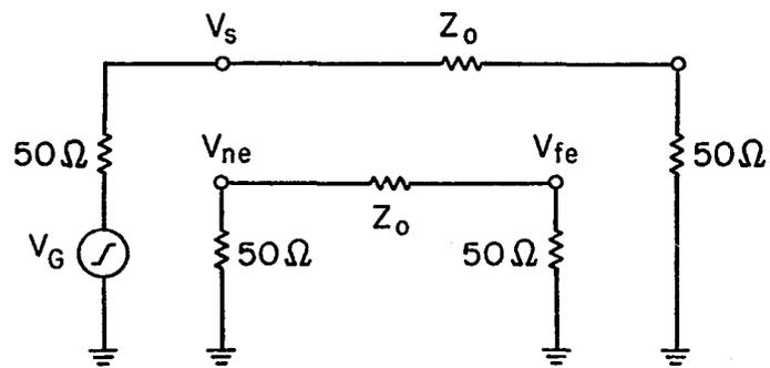
a. LOW IMPEDANCE TEST CIRCUIT
