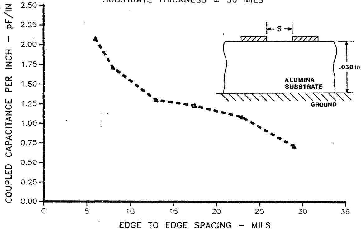
Figure 4.5 Edge to Edge Coupled Capacitance vs. Line Spacing
