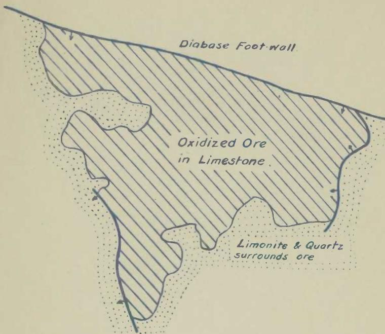
PLAN OF OXIDIZED OREBODY
