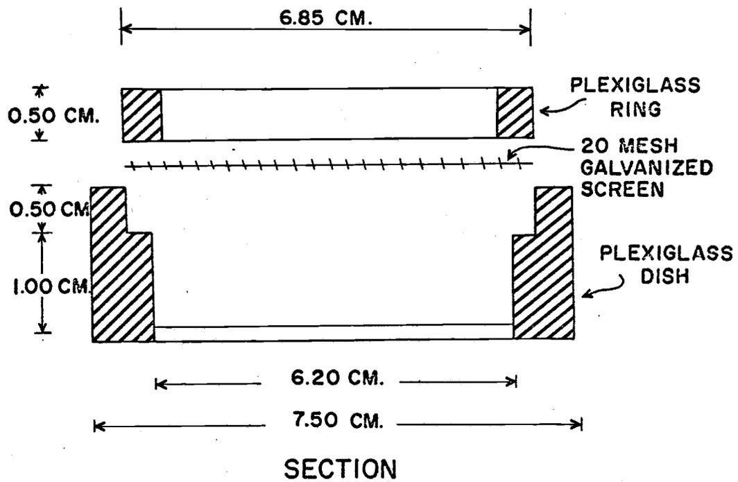
FIGURE 4. WATER VAPOR TRANSMISSION TEST DISH
