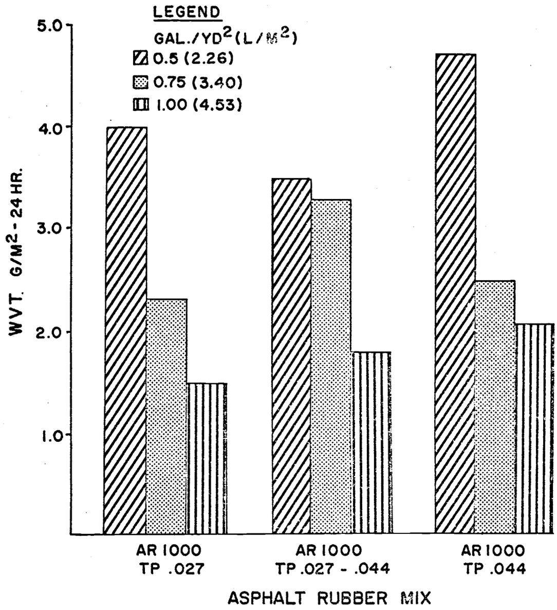
FIGURE 11. WATER VAPOR TRANSMISSION RATE FOR VARIOUS ASPHALT-RUBBER MEMBRANES
