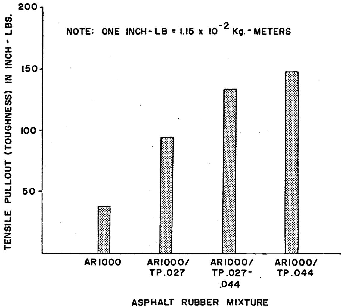
FIGURE 14. TOUGHNESS VALUES FOR ASPHALT AND ASPHALT RUBBER
