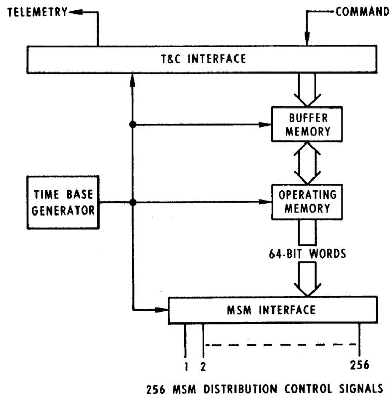
**Fig. 2 - DCU Block Diagram**
