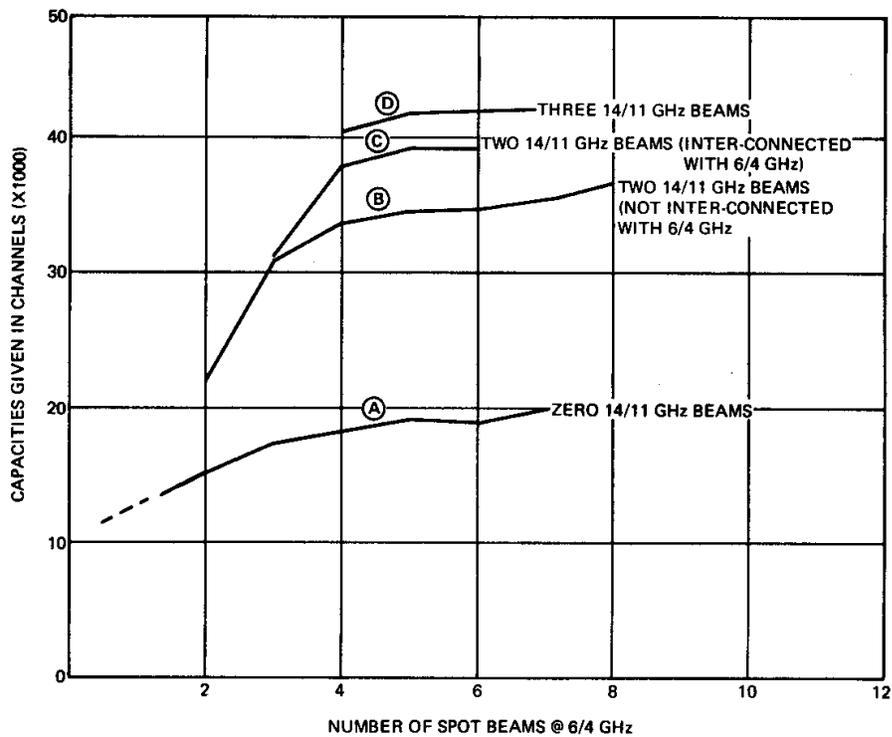
FIGURE 5 SATELLITE CAPACITY AS A FUNCTION OF THE BEAM CONFIGURATION
