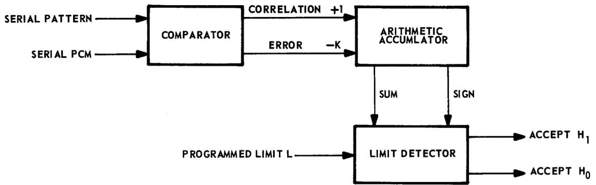
Fig. 4 - SPRT Block Diagram
