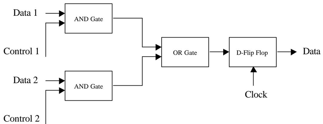
Figure 5) Hitless Switch Block Diagram
