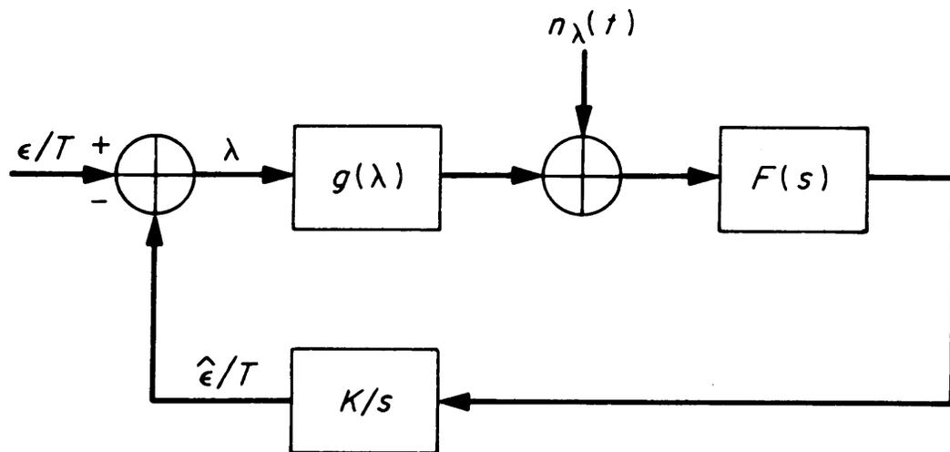
**FIG. 2. EQUIVALENT DATA-TRANSITION TRACKING LOOP MODEL**
