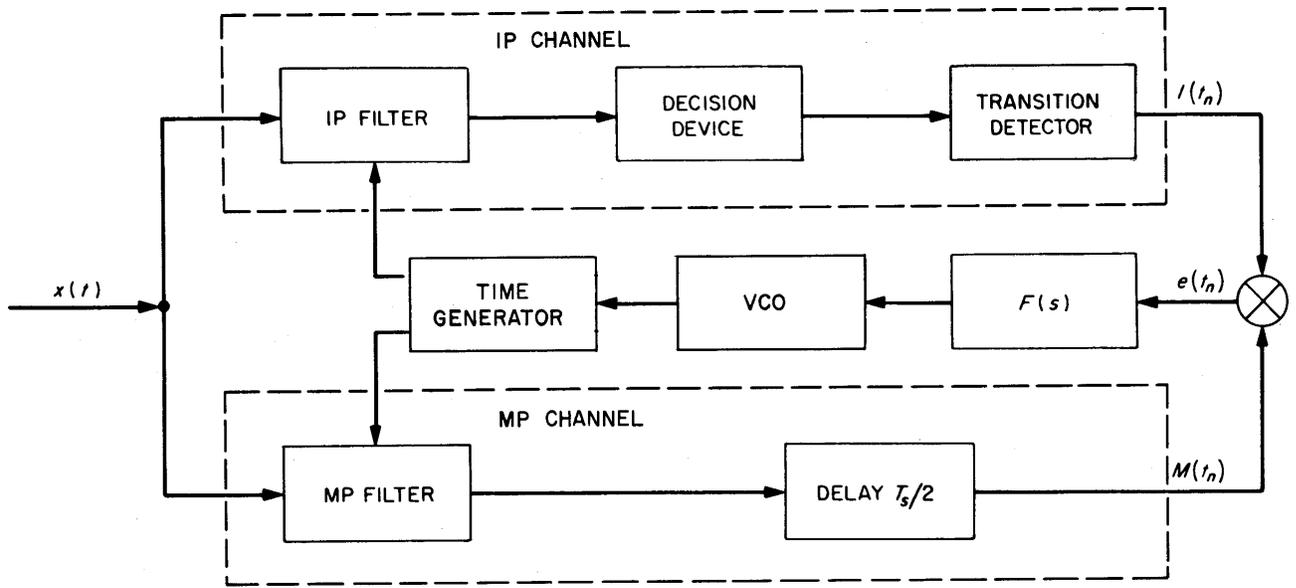
**Fig. 1. DATA-TRANSITION TRACKING LOOP**
