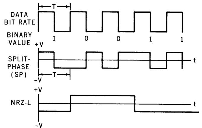
**Fig. 4 - Telemetry Data Codes.**
