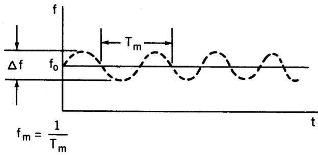
**Fig. 1 - Sinusoidal Jitter.**
