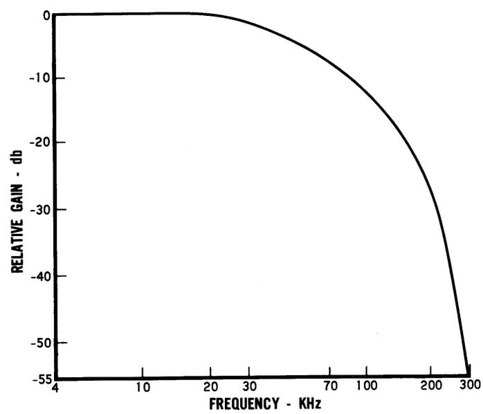
FIGURE 7 ROLL-OFF CHARACTERISTIC OF RECORD/REPRCDUCE PROCESS
