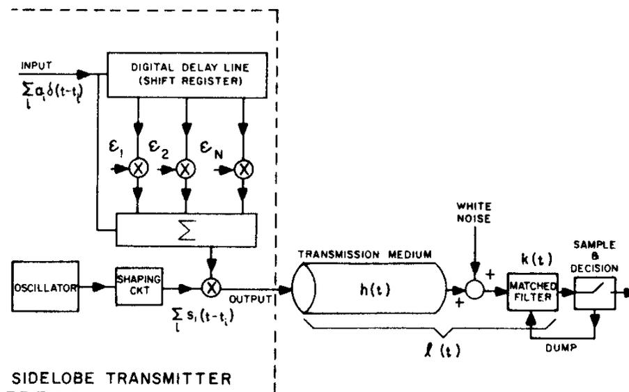
**FIG. 1 SYSTEM CONFIGURATION USING SIDELOBE TRANSMITTER**
