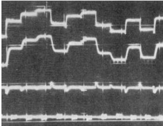
**FIGURE 5A. INPUT TO THE RECEIVER AT -56 DBM**
