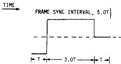
**FIGURE 7. PAM FRAME SYNCHRONIZATION PULSE**
