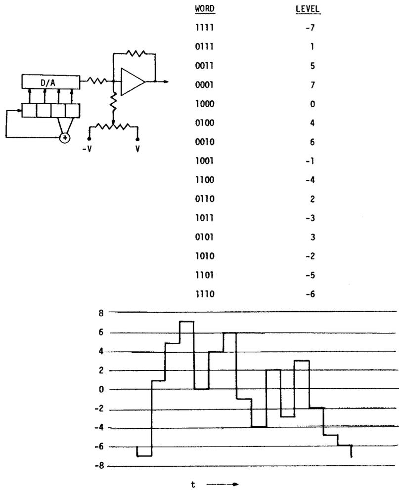
**FIGURE 1. PAM TEST SEQUENCE FROM 4 POSITION SHIFT REGISTER**
