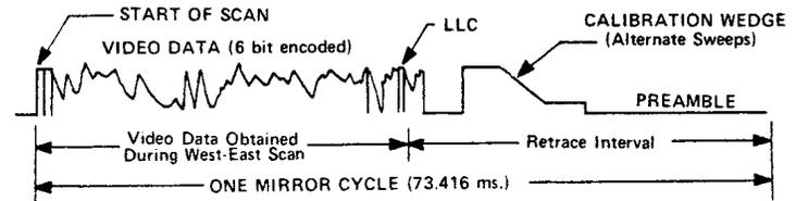
(B) MSS-VTR 25-TRACK DIGITAL TAPE FORMAT
