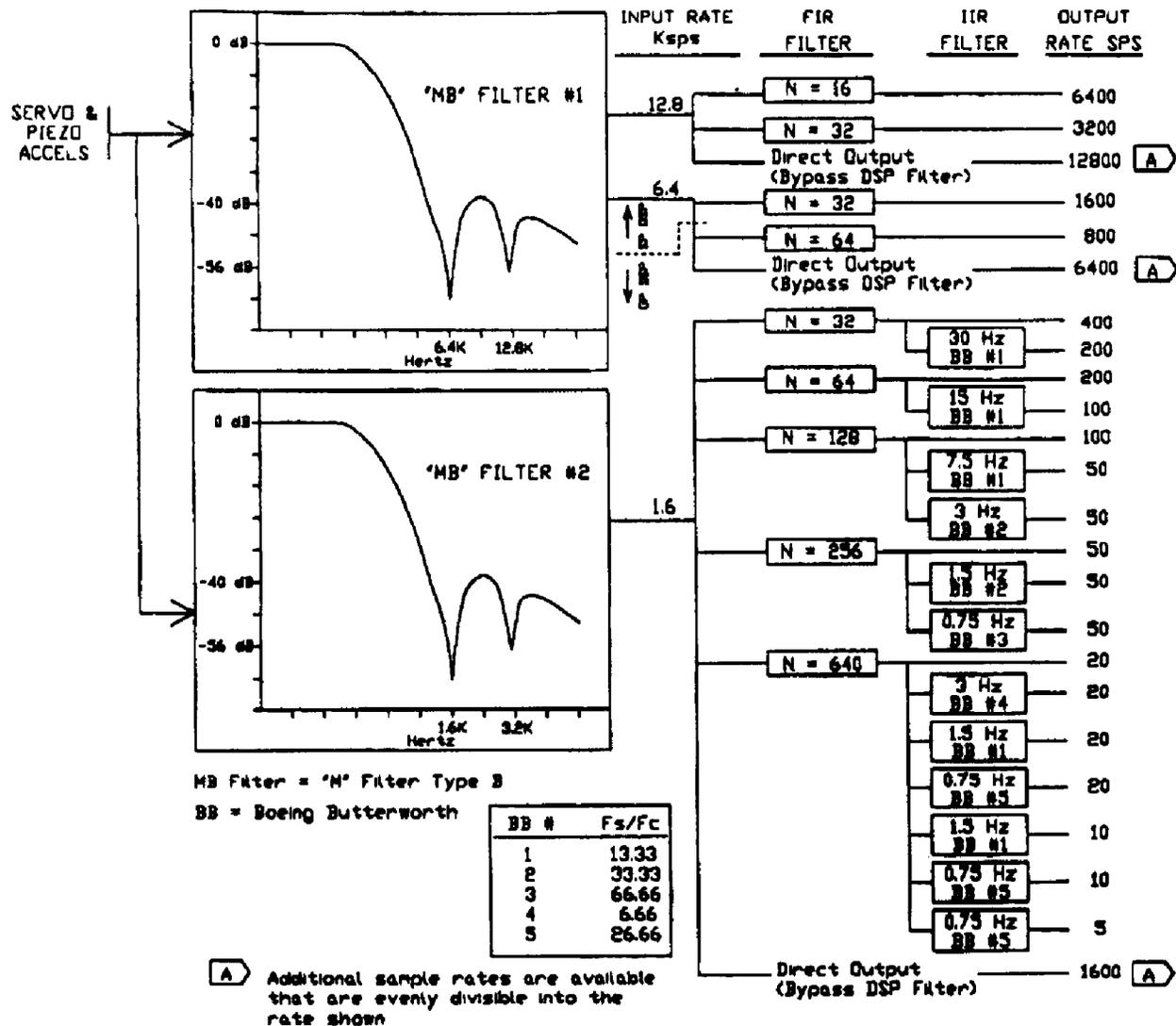
FIGURE 3 - TYPICAL FILTER TREE
