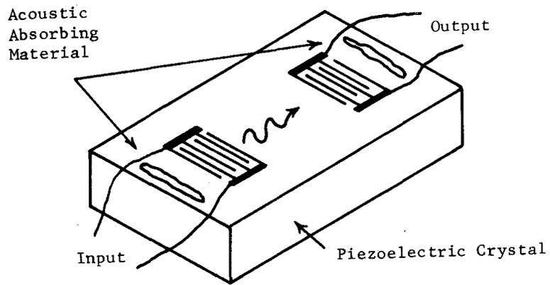
**FIGURE 1. BASIC SAW DELAY LINE**
