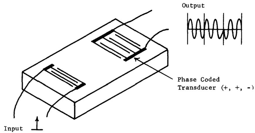
**FIGURE 4. PHASE CODED DELAY LINE**
