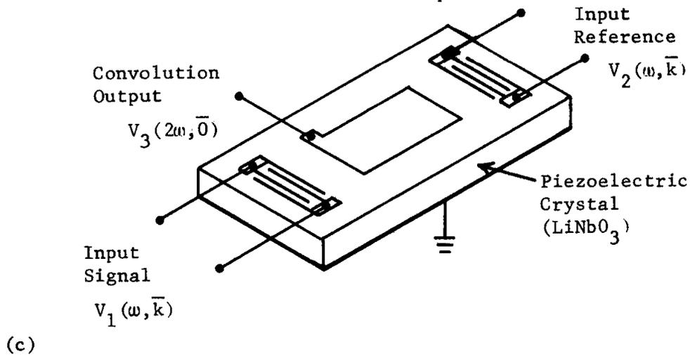
**FIGURE 6. PROGRAMMABLE SAW DEVICES a) CONVENTIONAL TAPPED DELAY LINE, b) DIODE-CORRELATOR, c) CONVOLVER.**
