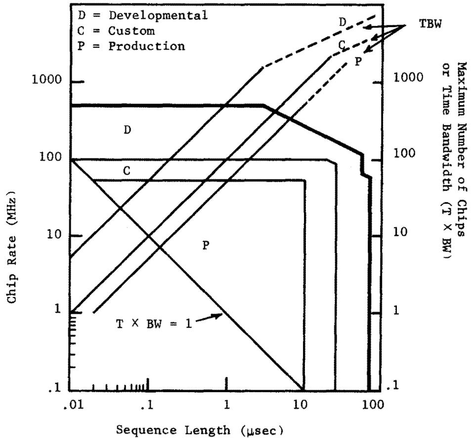
**FIGURE 5. FABRICATION CAPABILITIES FOR CODED DEVICES**
