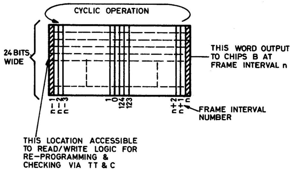
**FIG. 5 OPERATION OF CHIP A MEMORY**
