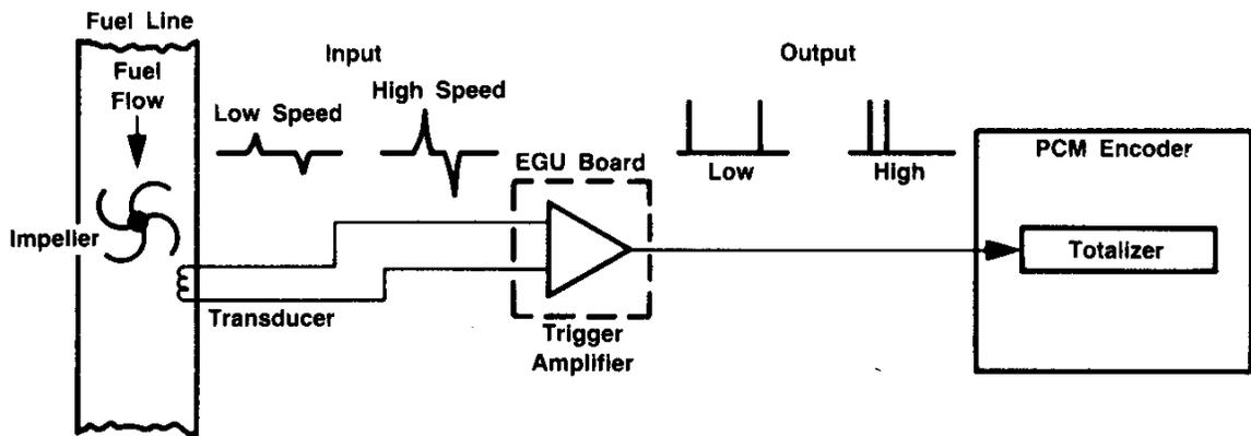
**Figure 3. ASALM Impeller-Type Flowmeter System**
