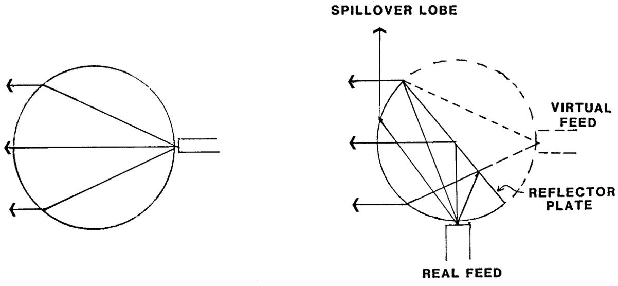
**FIGURE 3 VIRTUAL SOURCE LENS ANTENNA**
