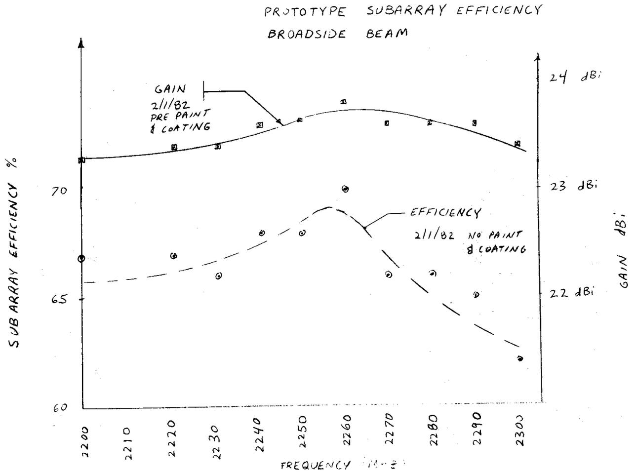
FIGURE 8. 64-ELEMENT SUBARRAY GAIN AND EFFICIENCY
