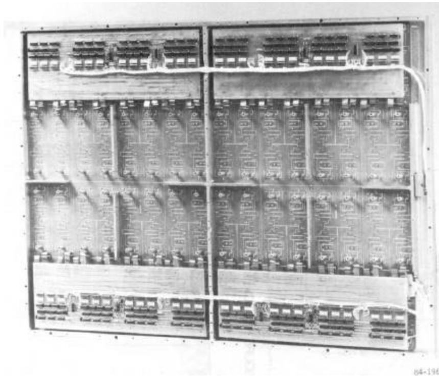
FIGURE 2. 128-ELEMENT SUBARRAY REAR VIEW
