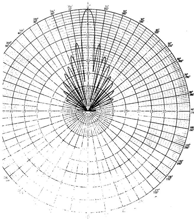
**FIGURE 10. BROADSIDE ELEVATION BEAM**
