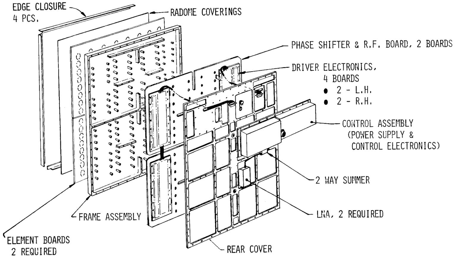
**FIGURE 1. SUBARRAY ASSEMBLY**
