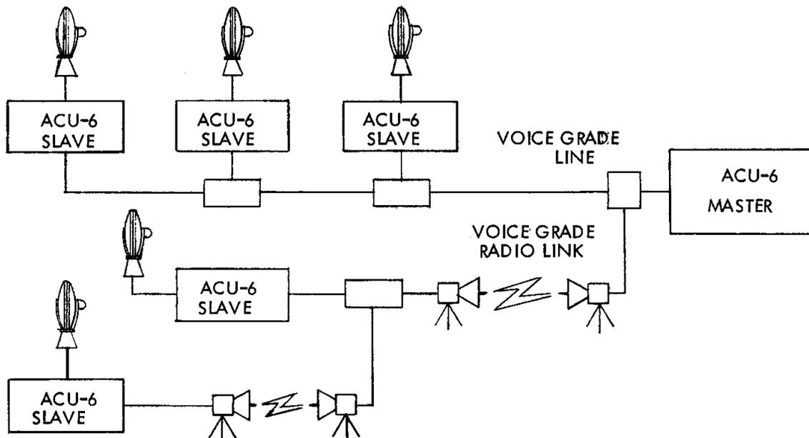
**FIGURE 5 - ACU-6 EXAMPLE NETWORK USING ACU-6 MASTER**
