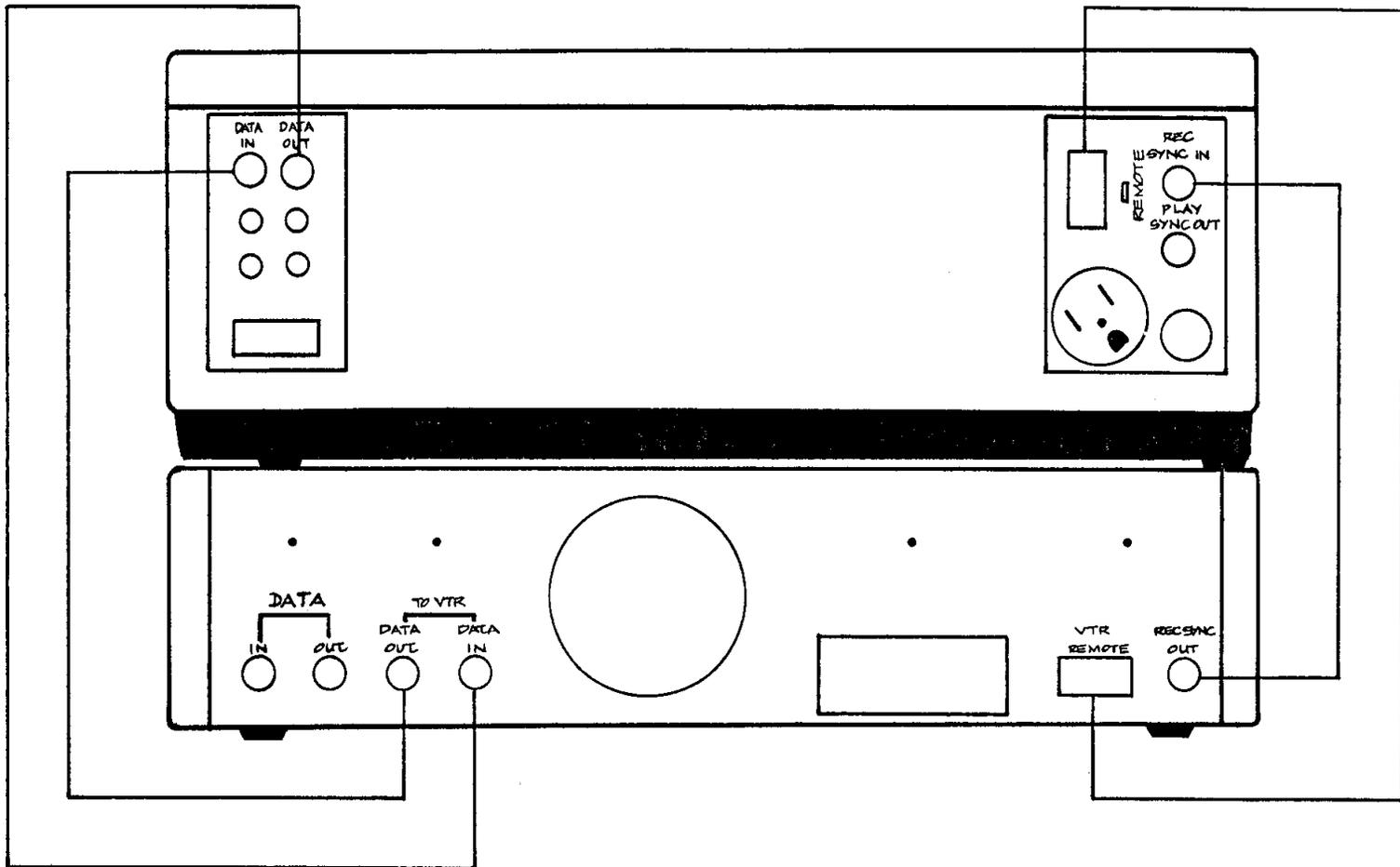
**FIGURE 3. DIGITAL DATA RECORDING SYSTEM, SYSTEM INTERCONNECT.**
