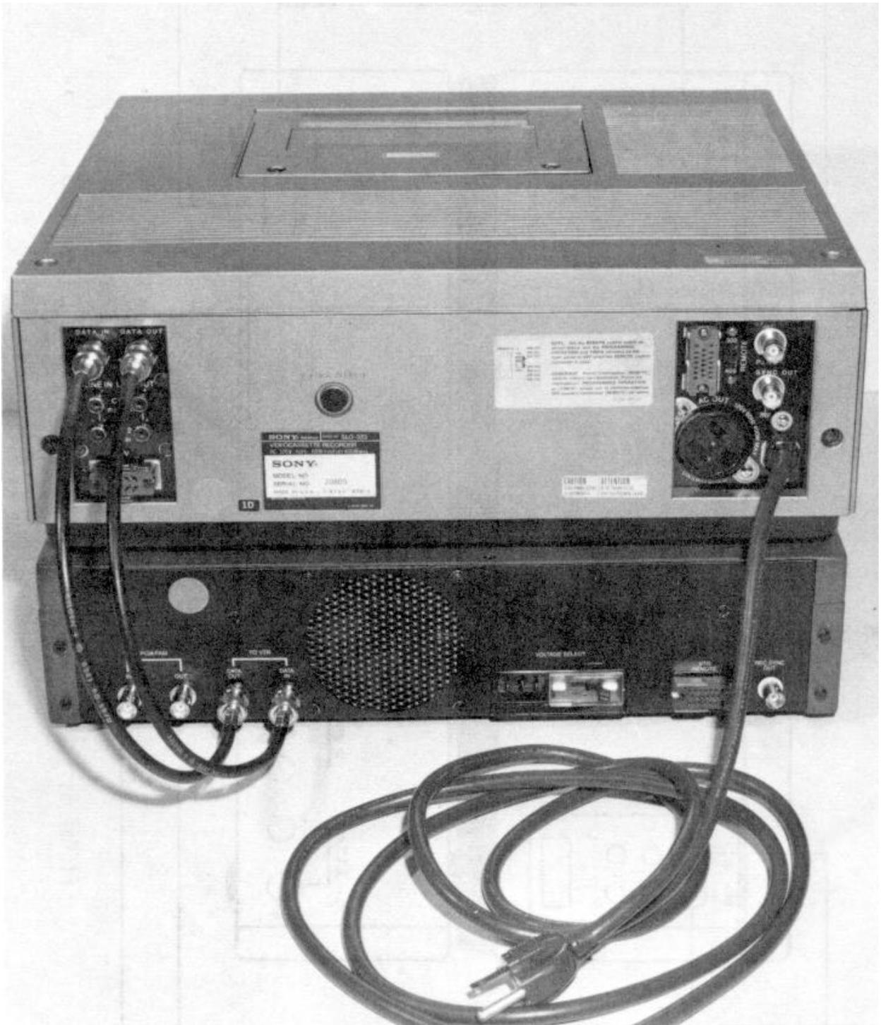
FIGURE 2. DIGITAL DATA RECORDING SYSTEM, REAR VIEW.
