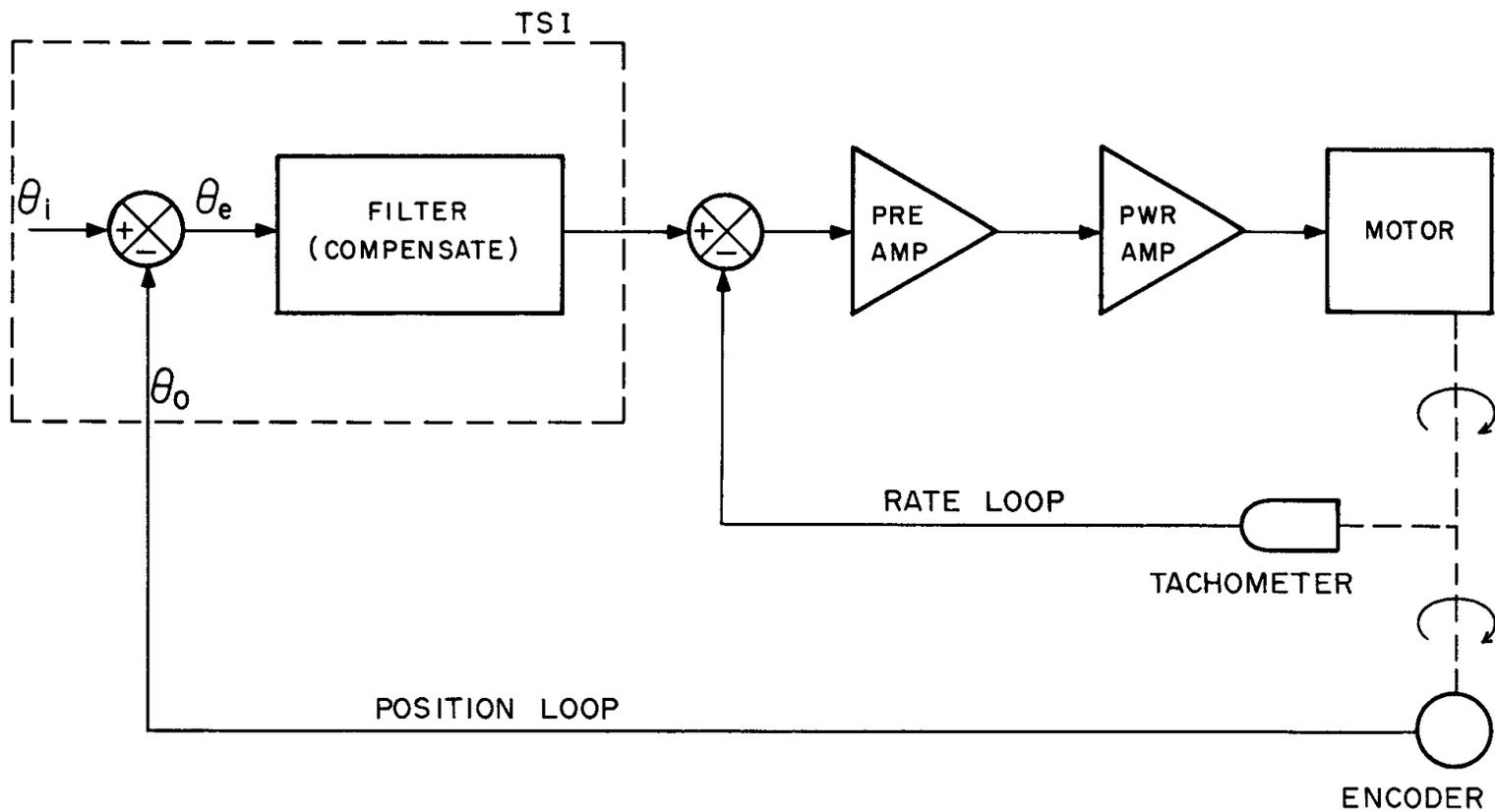
**FIGURE 10 TYPICAL SERVO SYSTEM**
