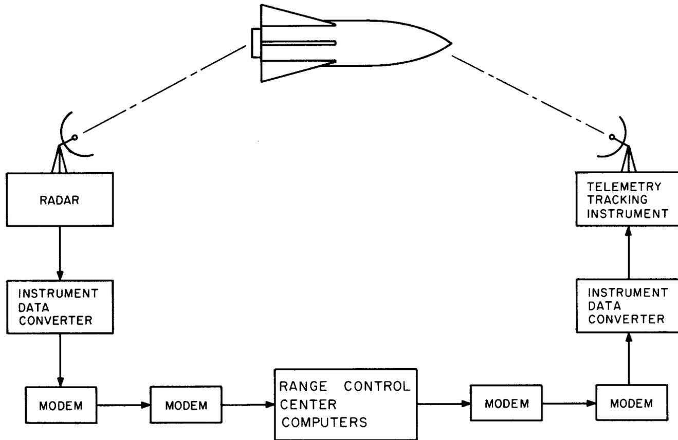
**FIGURE 3 TARGET ACQUISITION SYSTEM A**
