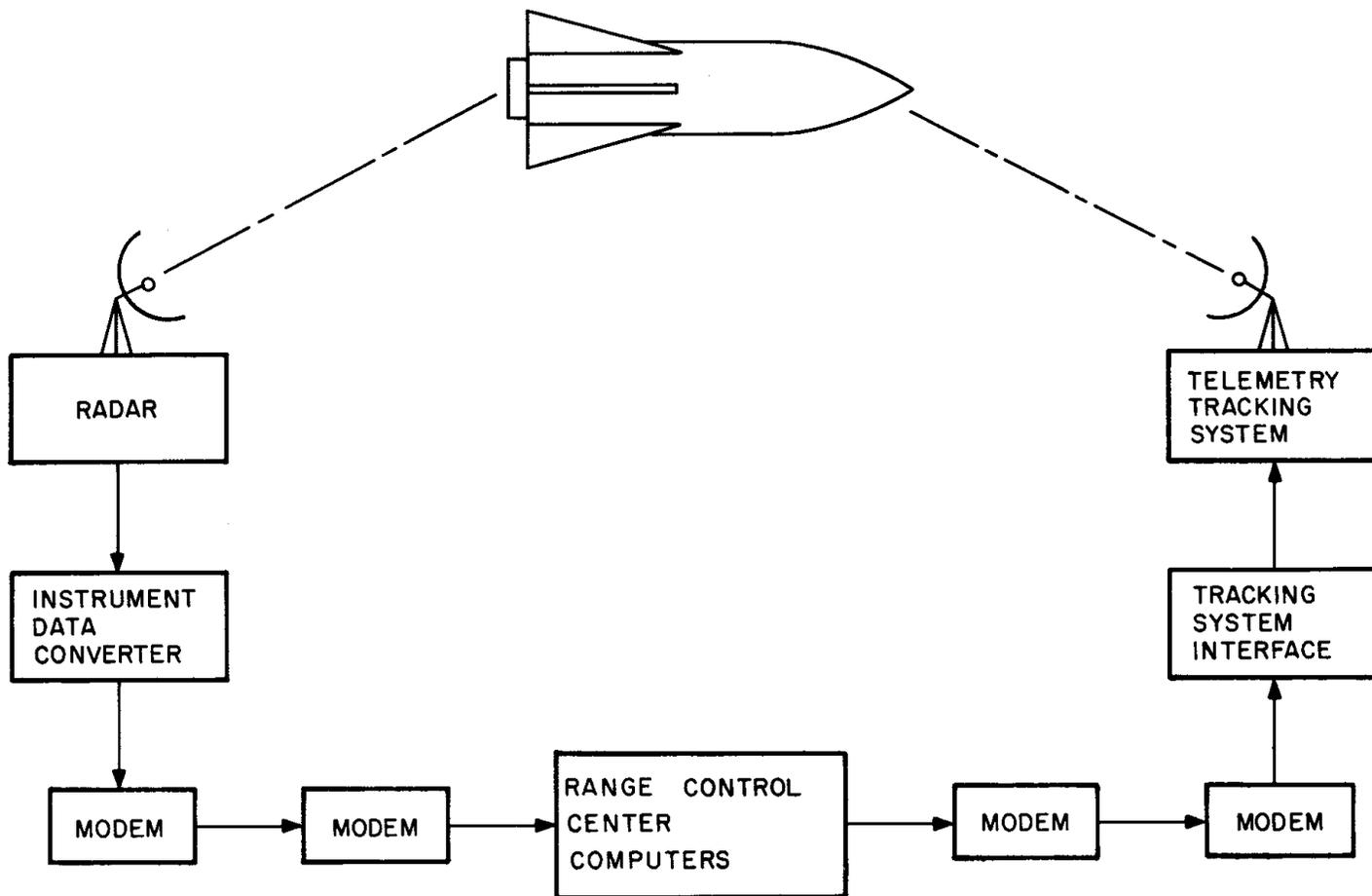
**FIGURE 8 TARGET ACQUISITION SYSTEM B**
