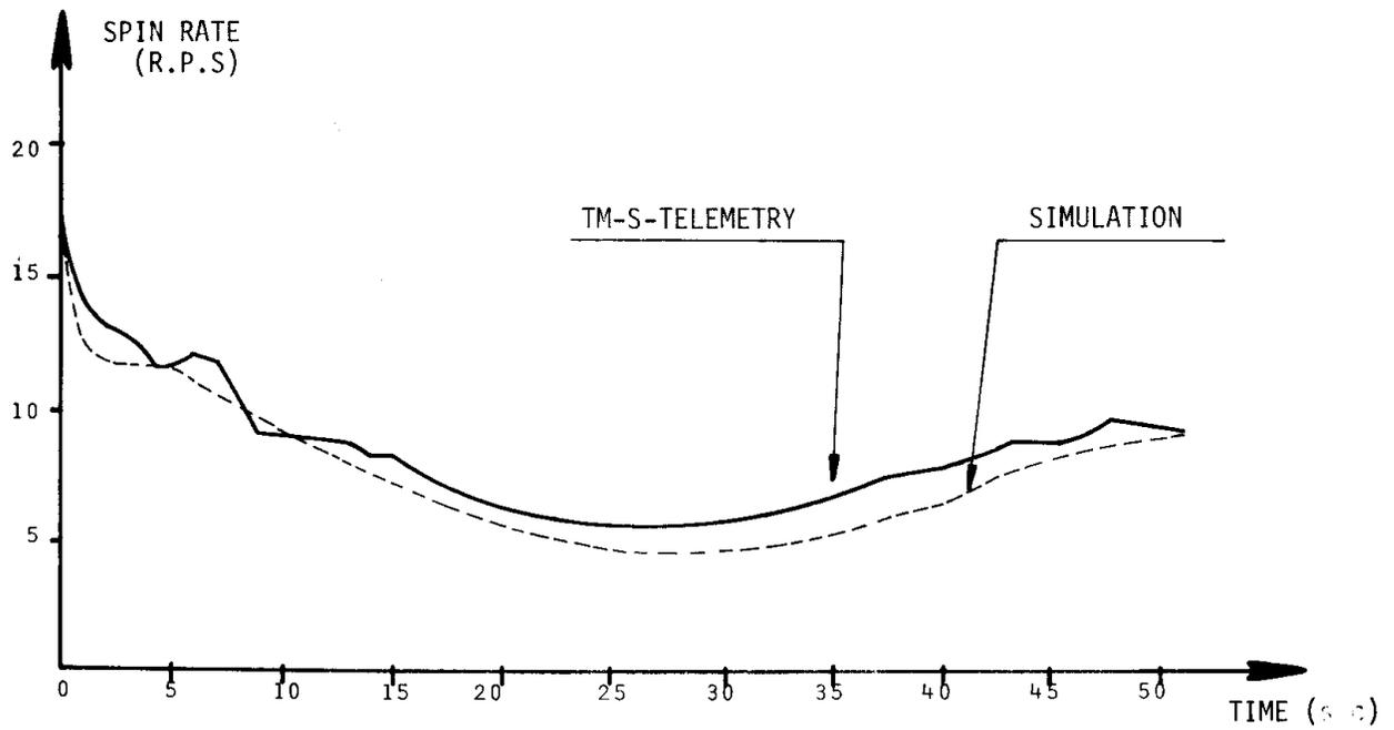
Fig 13 : SPIN RATE OF PROJECTILE DURING FLIGHT
