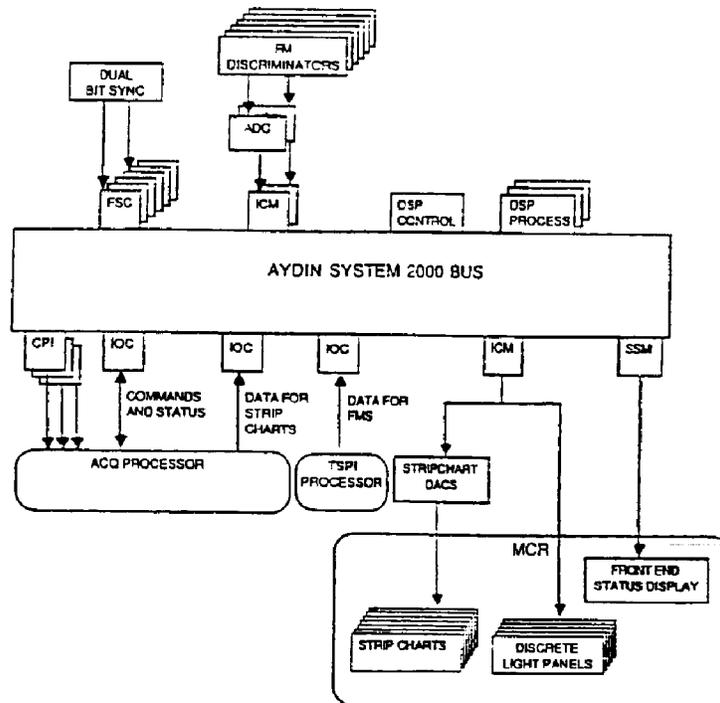
FIGURE 7. TSF-IFDAPS TM PROCESSING SYSTEM
