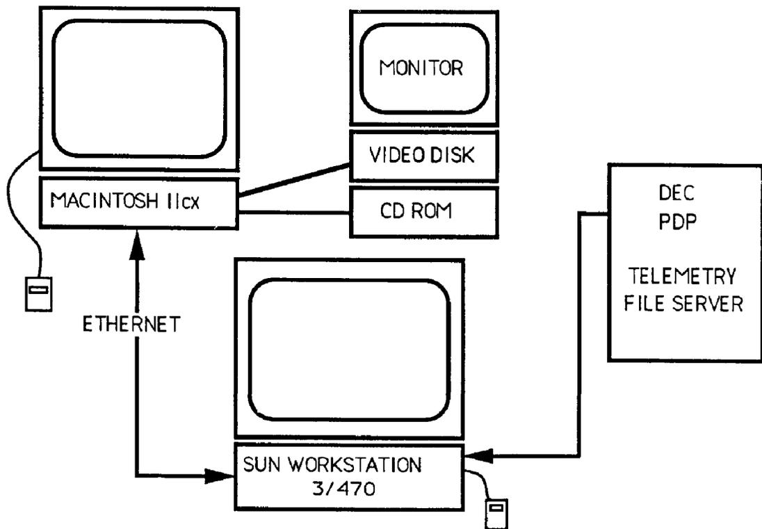
FIGURE 2. ASW BLOCK DIAGRAM
