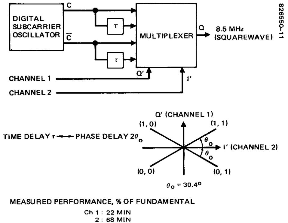
FIGURE 9. SQUARE WAVE SUBCARRIER UNBALANCED QPSK MODULATOR
