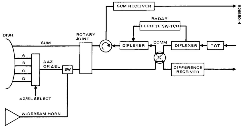
**FIGURE 16. ANTENNA SWITCHING**
