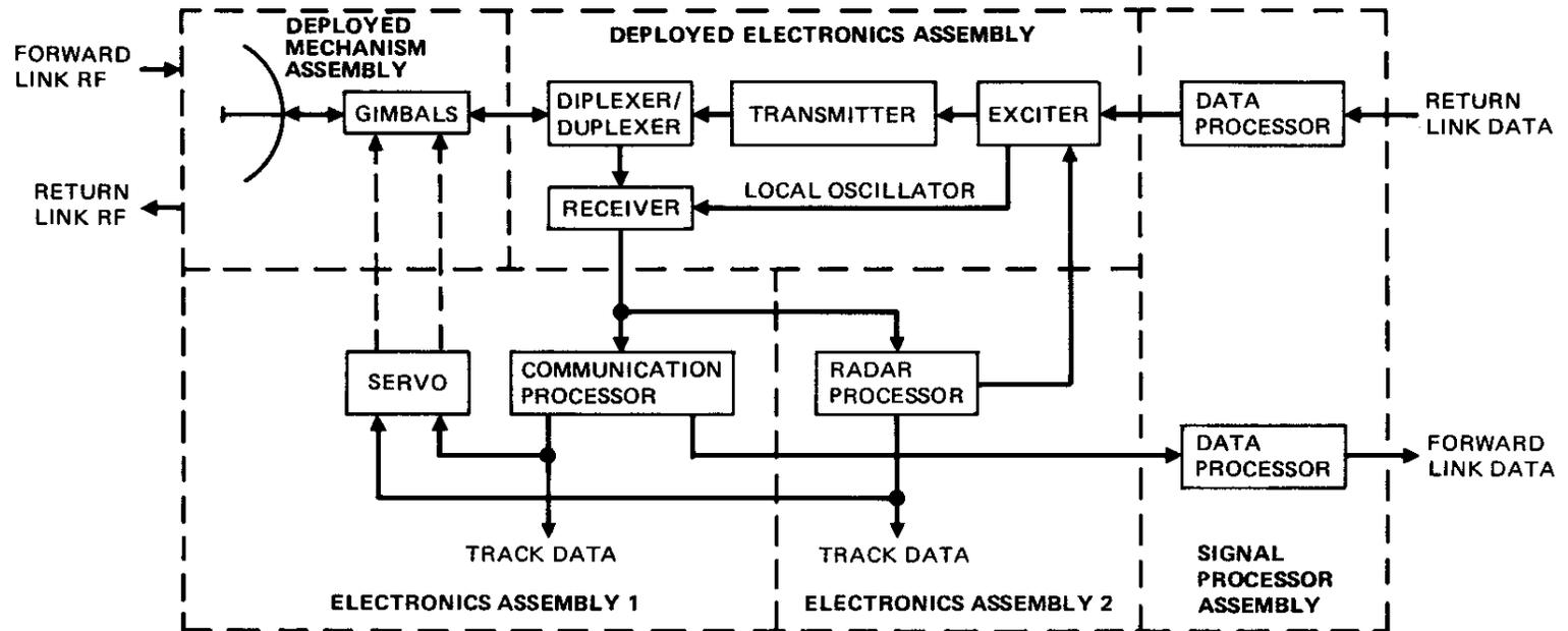
**FIGURE 3. Ku BAND SYSTEM BLOCK DIAGRAM**
