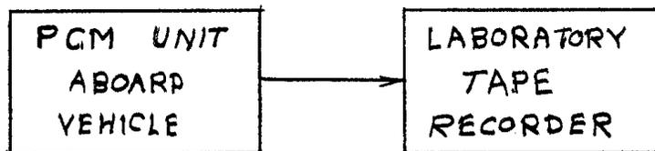
RECORDING A TEST ON GROUND
