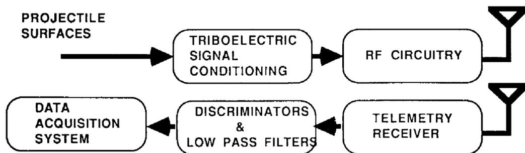
FIG.2 TRIBOELECTRIC MEASUREMENTS VIA TELEMETRY
