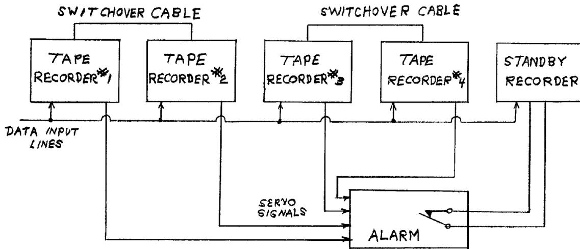
**FIGURE #8 ALARM CONNECTED TO STANDBY RECORDER FOR REDUNDANT RECORDER SET UP**
