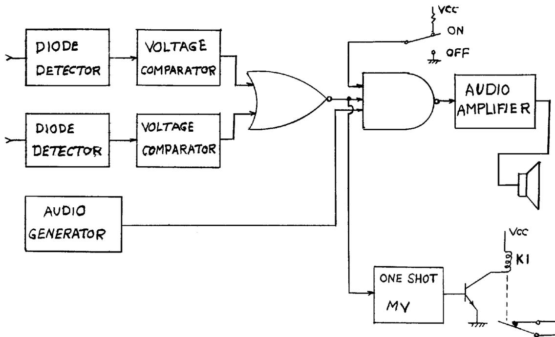
**FIGURE #4 TAPE RECORDER SHUTDOWN ALARM EQUIPPED TO START STANDBY RECORDER**
