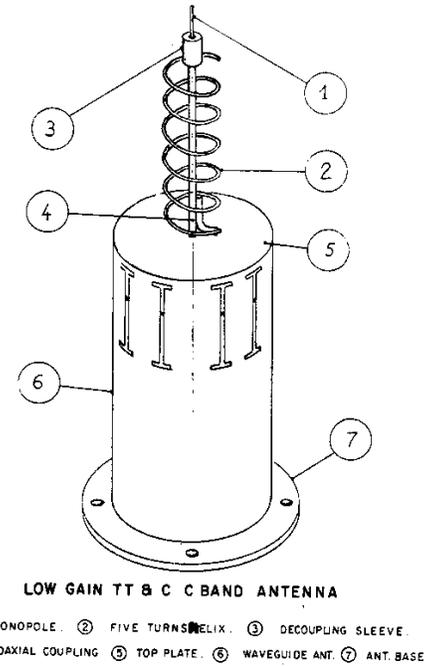
**LOW GAIN TT & C BAND ANTENNA**
