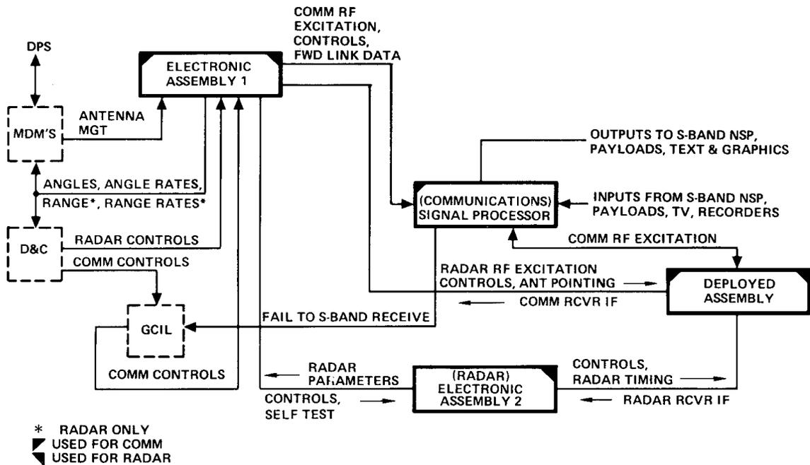
**Figure 8. Ku-Band Subsystem Block Diagram**
