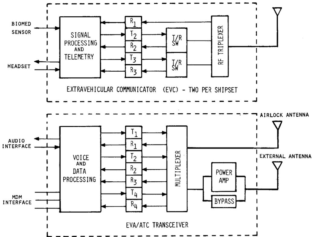
**Figure 9. EVA/ATC Subsystem Block Diagram**
