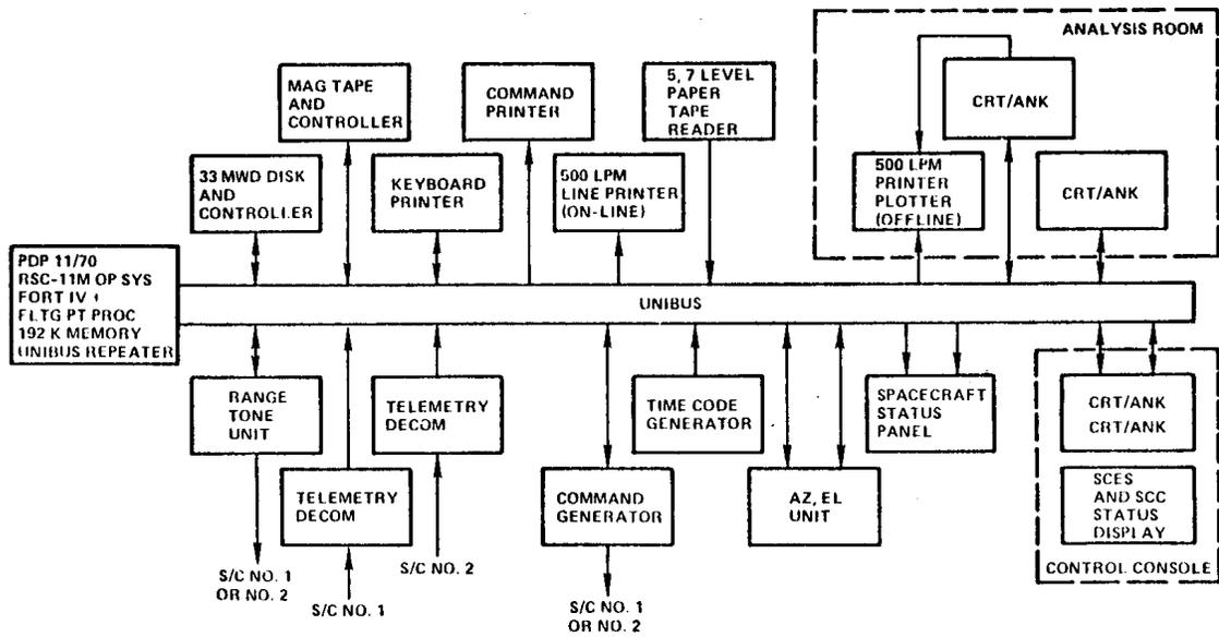
**Figure 4. Computer Subsystem Diagram**
