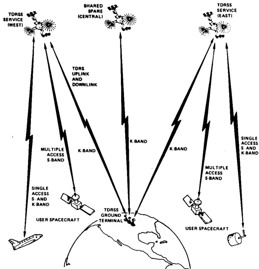
**FIGURE 1. TDRSS CONFIGURATION**
