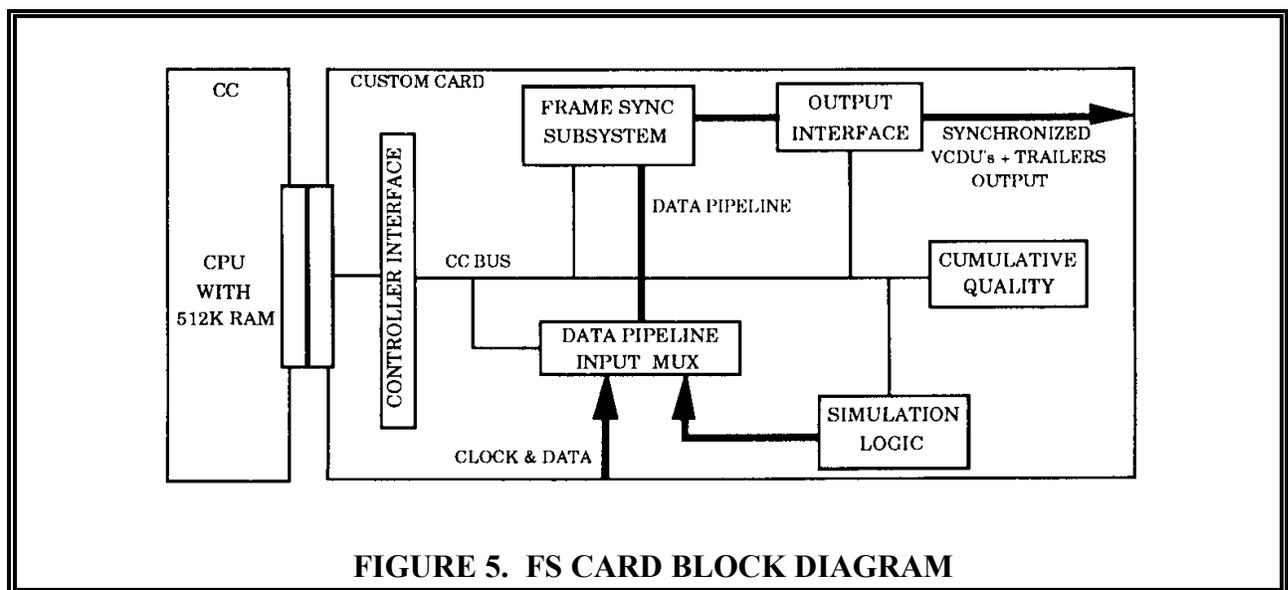
FIGURE 5. FS CARD BLOCK DIAGRAM
