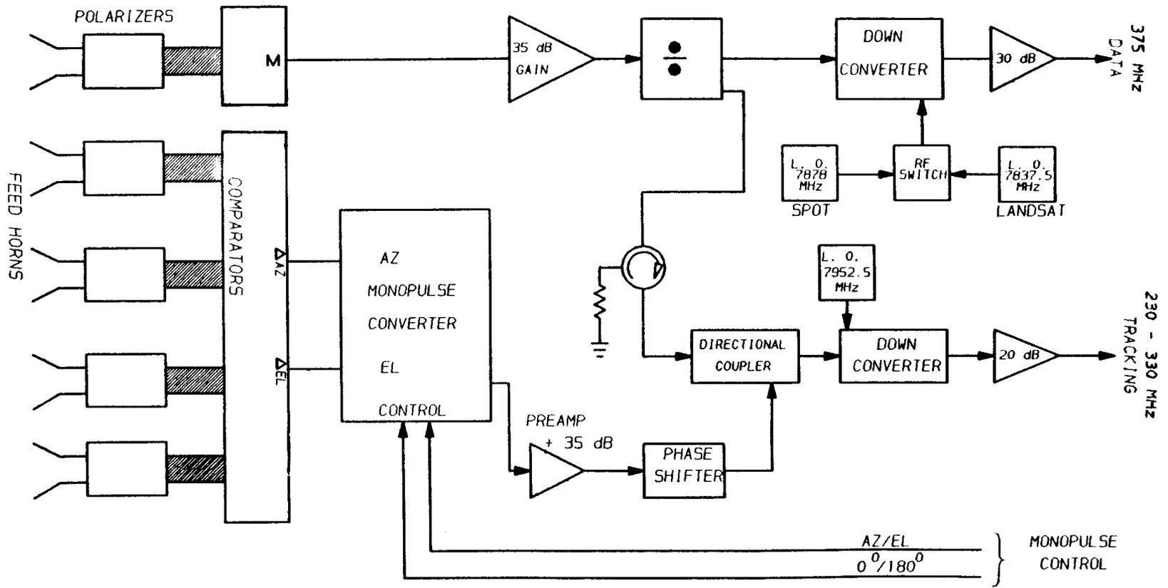
**Figure 7. X-Band Feed Block Diagram**
