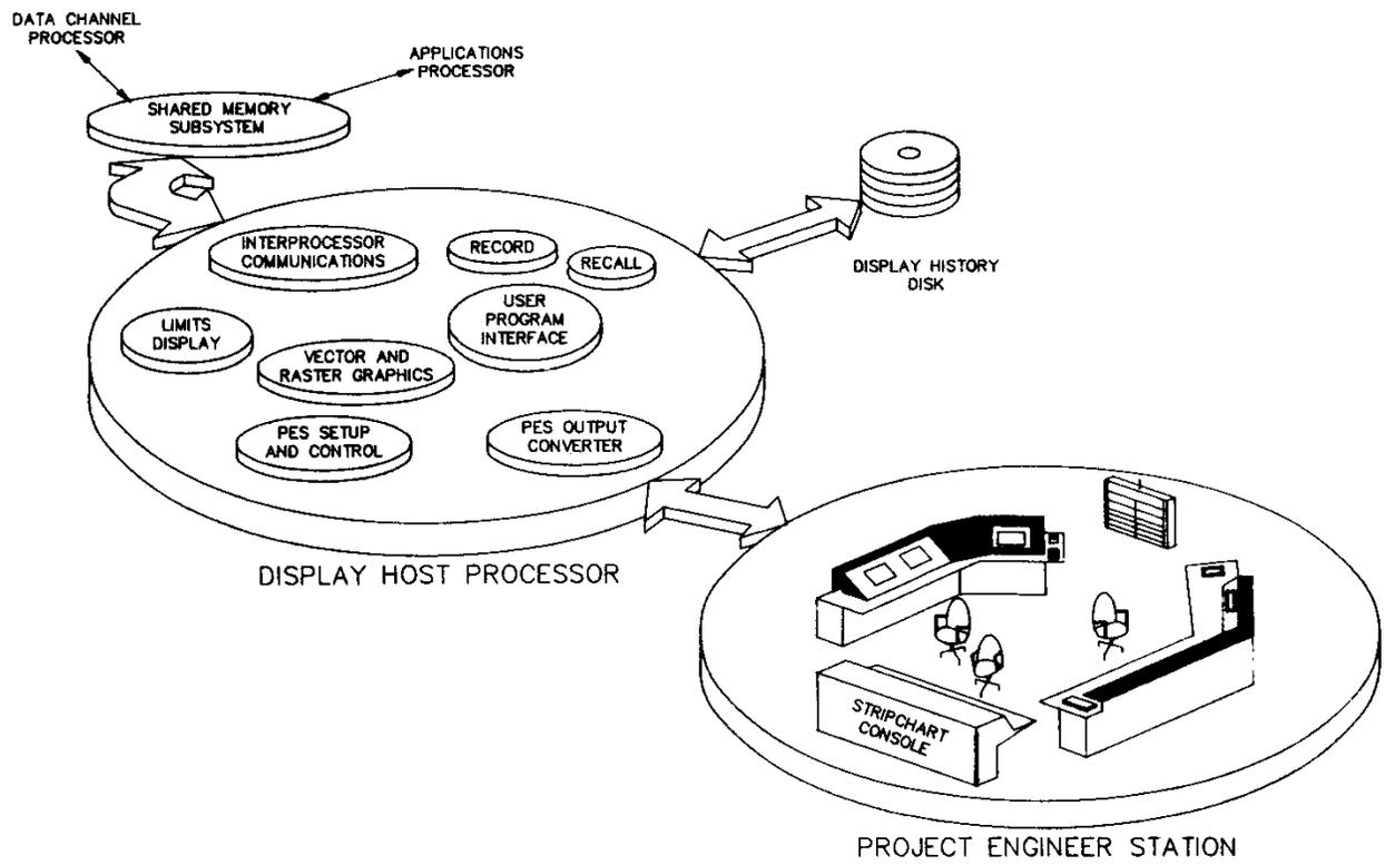
**Figure 4. Display Subsystem
