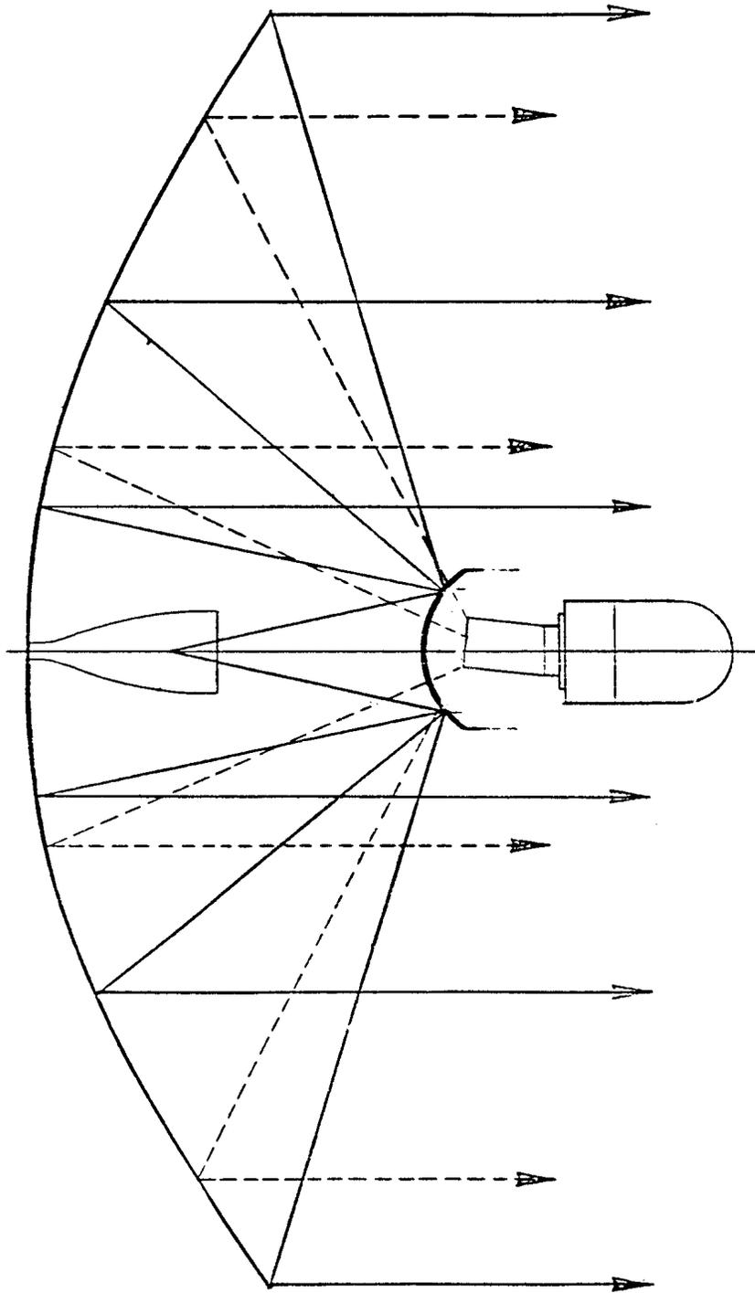
**FIGURE 2 DUAL FREQUENCY ANTENNA GEOMETRY**
