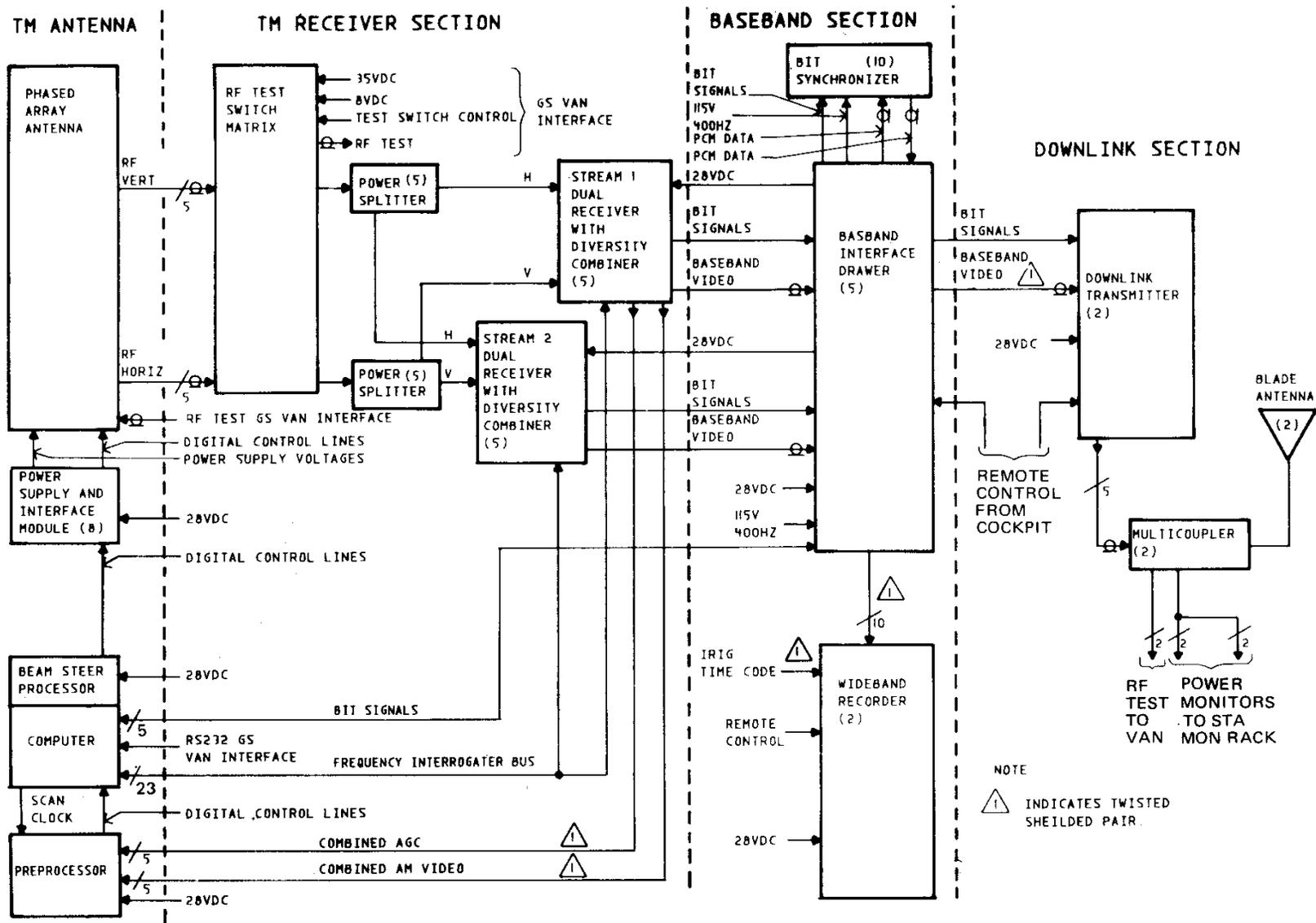
FIGURE 4. TM RELAY SUBSYSTEM BLOCK DIAGRAM
