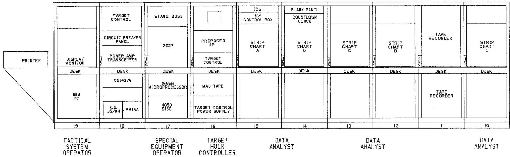
**FIGURE 3 - UC-880 RACK LAYOUT**
