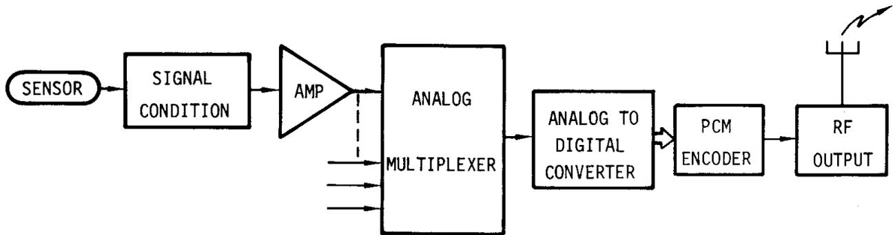
**FIGURE 1. STANDARD TELEMETRY SYSTEM**
